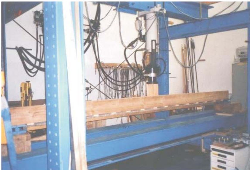
Unterspannter Balken im Last-Verformungs-Versuch
