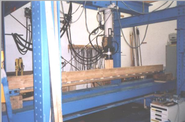
Unterspannter Balken im Last-Verformungs-Versuch
